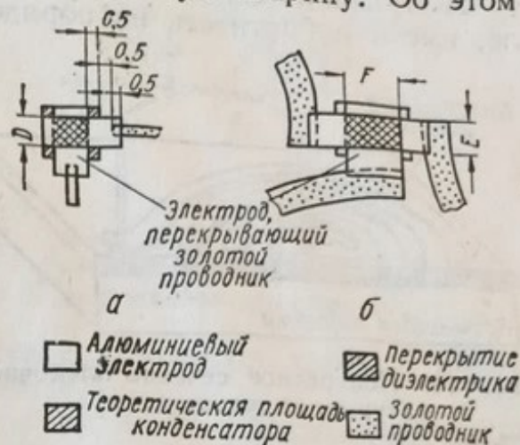
Рис. 13. Конструктивные формы конденсаторов (размеры в мм):
